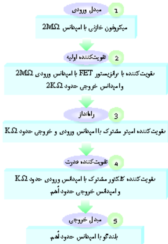
شکل ۴-۴- بلوک دیاگرام اتصال چندطبقه تقویت کننده به هم
