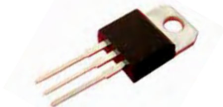
شکل ۴-۴۱- زوج دارلینگتون در یک بسته بندی
