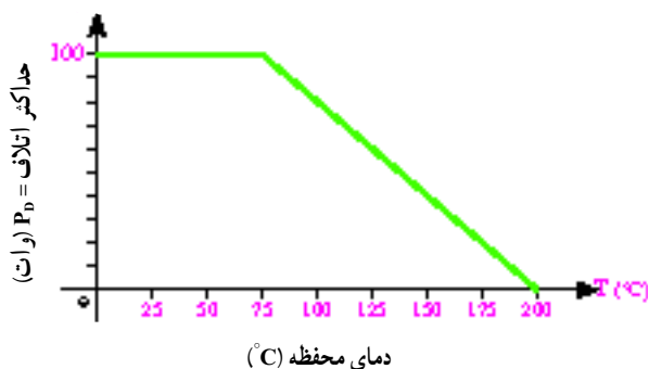
شکل ۳۱-۵ - منحنی اتلاف توان برای ترانزیستورهای سیلیکون
