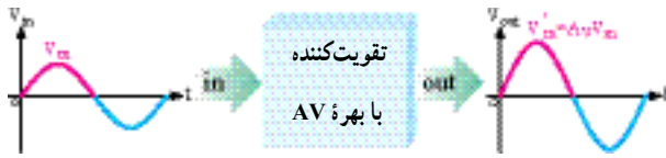
شکل ۸۵-۲- نمای بلوکی تقویت کننده
