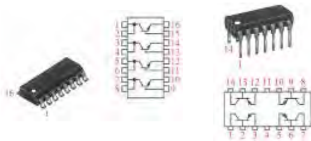
(ت) چهار ترانزیستور در یک بسته بندی به صورت DIPIC (ج) چهار ترانزیستور در بسته بندی نصب سطحی
