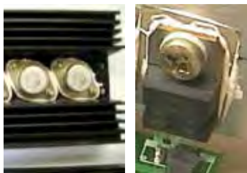
شکل ۳۲-۵- ترانزیستورهای قدرت که به رادیاتور اتصال دارند.
