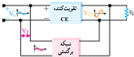
شکل ۲-۵۲- بلوک دیاگرام تقویت کننده با فیدبک
