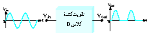
شکل ۵-۷. بلوک دیاگرام تقویت کننده کلاس B و شکل موج ورودی و خروجی آن
