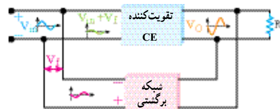
شکل ۲-۵۴- بلوک دیاگرام تقویت کننده با فیدبک منفی
