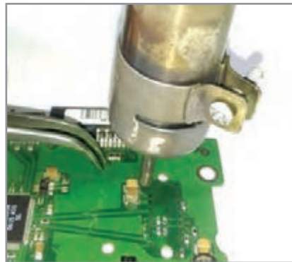
شکل ۲-۳ دمونتاز خازن سرامیکی و الکتrolیت SMD
