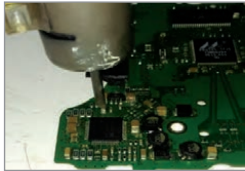
شکل ۲-۴ دمونتاز آی سی های چهار طرفه (خرچنگی)
