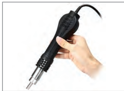
شکل ۷-۱ چگونگی صحیح در دست گرفتن هویه
