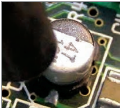
شکل ۲-۳ دمونتاز خازن سرامیکی و الکتrolیت SMD
