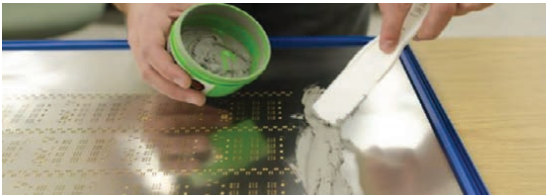
شکل ۱۲-۳ خمیر اندود کردن لحیم به کمک شابلون
