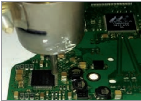
شکل ۲-۴ دمونتاز آی سی های چهار طرفه (خرچنگی)
