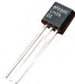
ب) LM۳۵ خروجی ولتاژ
