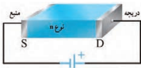
شکل ۴-۱۷- نیمه‌هادی با ناخالصی N به عنوان کانال
