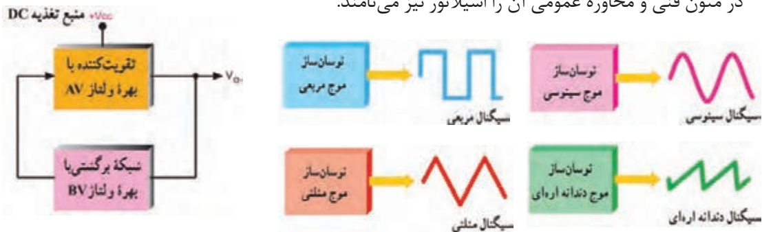
شکل ۶-۲۴ انواع نوسان ساز با توجه به شکل موج تولیدی
