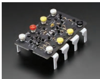
شکل ۴-۵۴- مدار داخلی آی سی ۷۴۱ با قطعات مجزا
