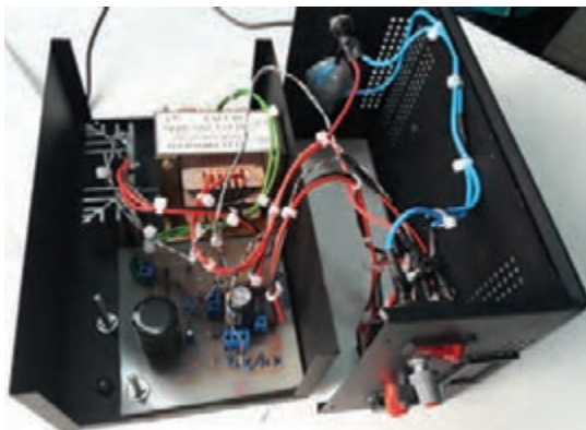
شکل ۲-۱۳ پنل منبع تغذیه ساخته شده با LM338 شکل ۲-۱۴ مدار داخلی و قطعات منبع تغذیه ساخته شده با LM338
