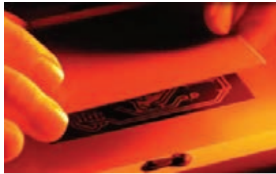
شکل ۳-۲۱- قرار دادن فیبر روی نقشه
