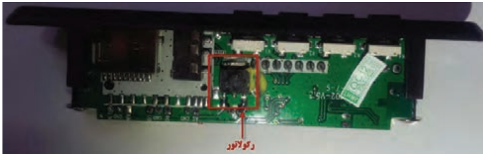
شکل ۵-۸- برد MP۳ با رگولاتور ۷۸۰۵ داخلی
