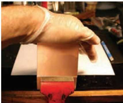
شکل ۳-۵- شکستن فیبر خام به وسیله گیره فلزی
