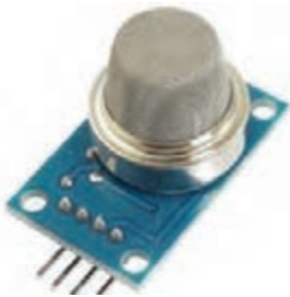
شکل ۹۸-۴- ماژول تشخیص گاز خانگی
