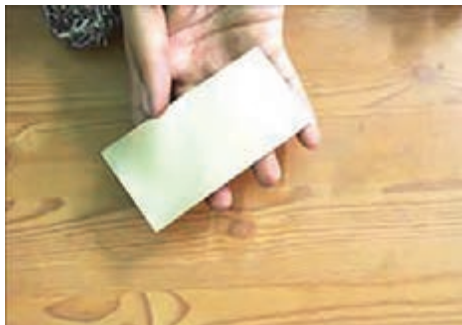
شکل ۳-۱۰- فیبر مسی تمیز شده
