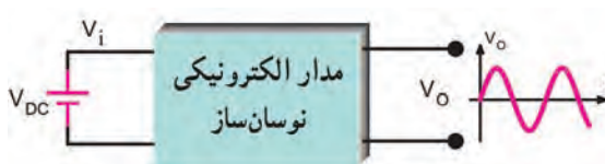
شکل ۶-۲۳ نقشه بلوکی نوسان‌ساز سینوسی
