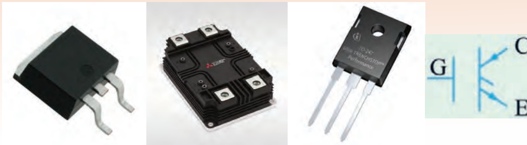
شکل ۴-۴۴ نماد و شکل نمای ظاهری چند نمونه IGBT
