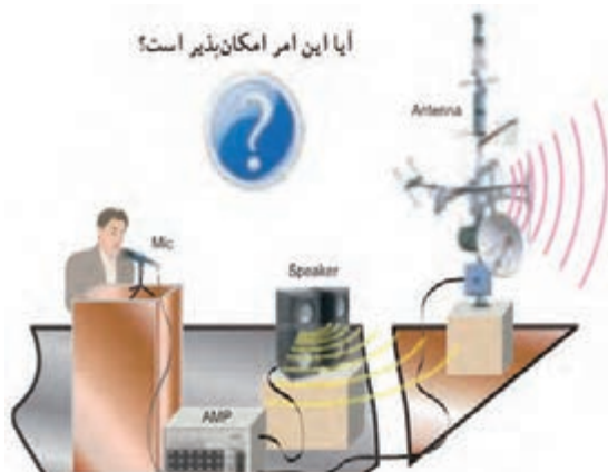
شکل ۶-۴۷ تبدیل امواج صوتی به امواج الکترومغناطیس
