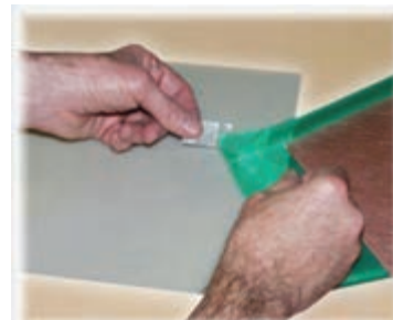
شکل ۳-۱۱- جدا کردن روکش لمینت
