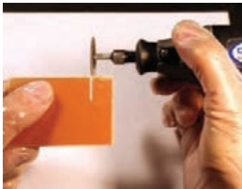
شکل ۸-۳- بریدن فیبر با مینی‌فرز
