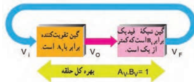
شکل ۶-۳۰ بررسی اصل بارک‌هاوزن
