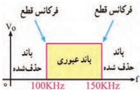
شکل ۵-۶ منحنی پاسخ فرکانسی فیلتر ایده‌آل
