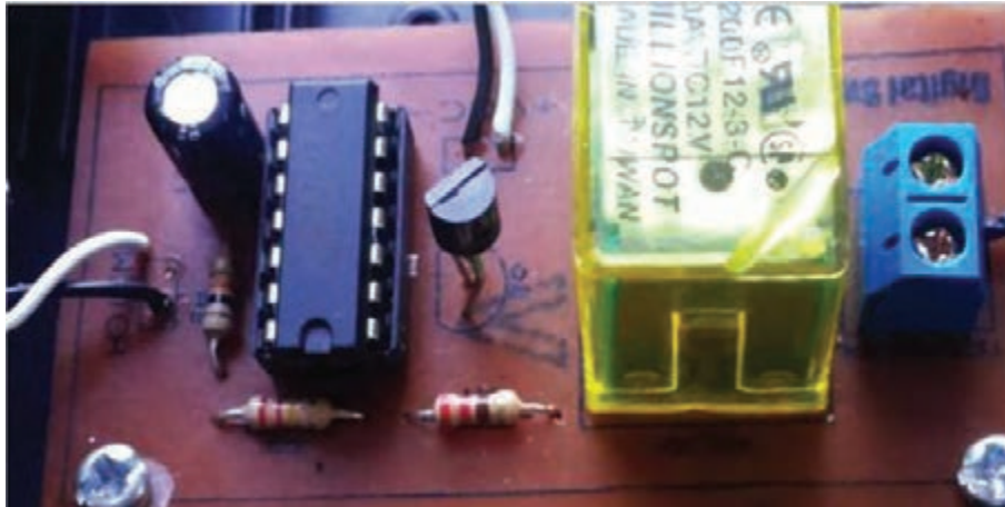
شکل ۹۶-۴ مدار مونتاژ شده کلید الکترونیکی
