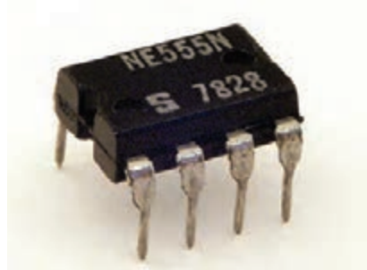
شکل ۲-۲۰- آی‌سی تایمر NE555
