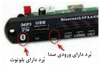
شکل ۵-۷- بُرد دارای بلوتوث و ورودی صدا
