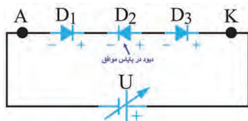
شکل ۷-۵ دیود چهار لایه در بایاس مخالف
