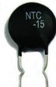
الف) NTC خروجی مقاومت
