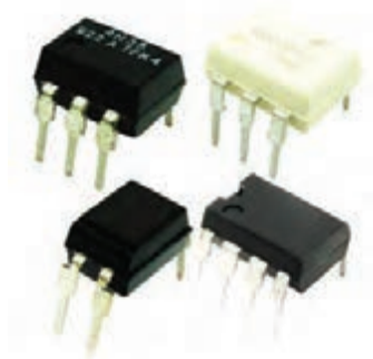
شکل ۷-۶۷ چند نمونه اپتوکوپلر
