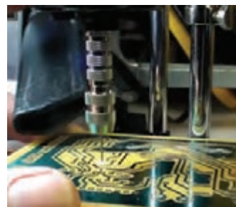
شکل ۳-۲۹- سوراخ کاری فیبر مدار چاپی
