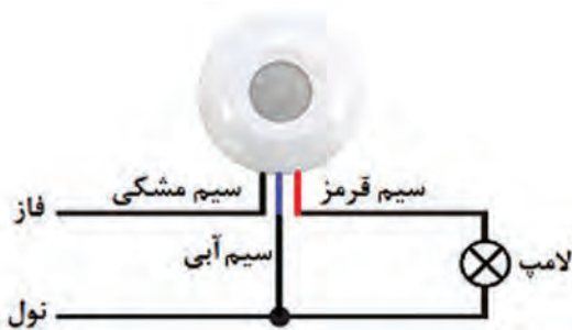
شکل ۲۸-۲ اتصال حسگر حرکتی به شبکه و لامپ
