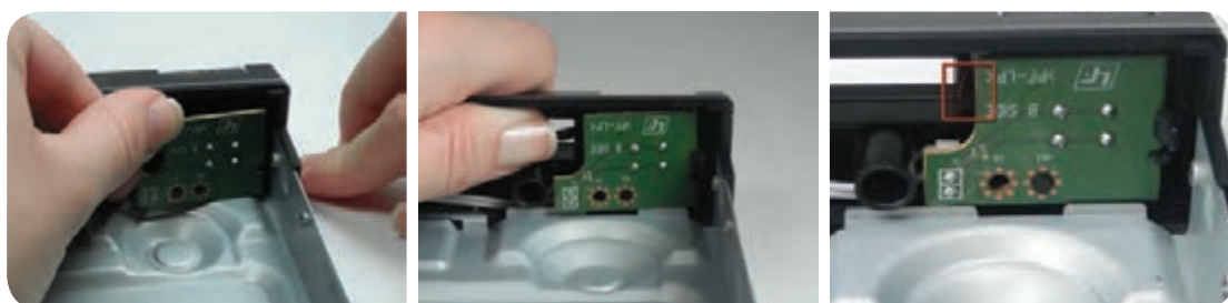
شکل ۶-۳۳ محل زائده پلاستیکی شکل ۶-۳۴ فشار دادن زائده پلاستیکی شکل ۶-۳۵ دمونتاژ برد کوچک
