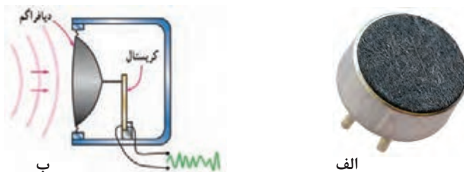
شکل ۱۶-۵- میکروفون کریستالی و ساختمان داخلی آن
