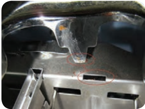
شکل ۵۸-۶ خار نر و ماده جهت اتصال
