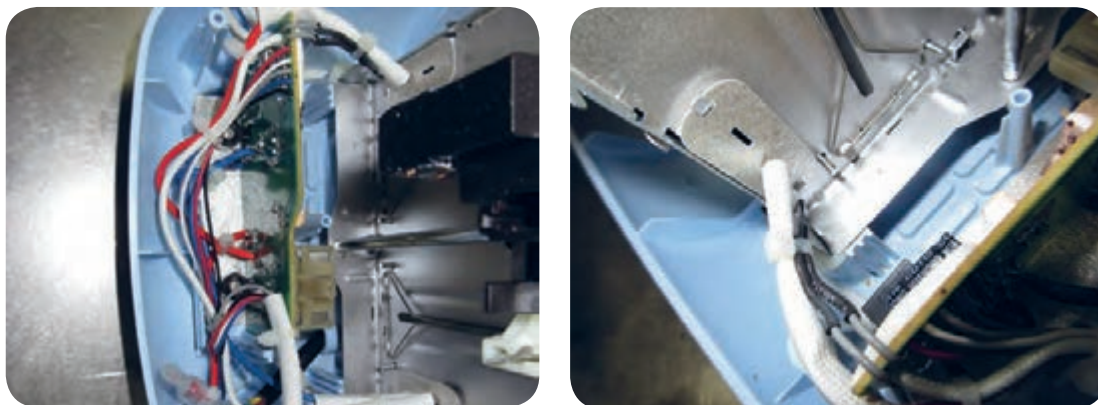
الف شکل ۶-۴۹ محل قرار گرفتن حسگر حرارتی
