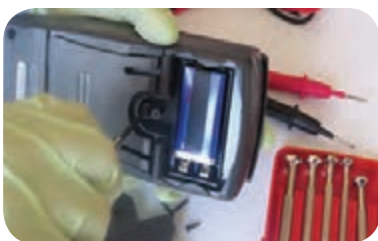
شکل ۱-۱۴- باز کردن پیچ‌ها و آزادسازی خارها
