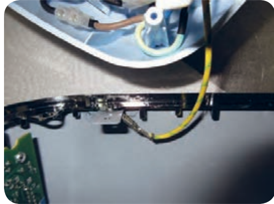
الف ب شکل ۵۶-۶ محل اتصال سیم زمین به نقاط مختلف توستر
