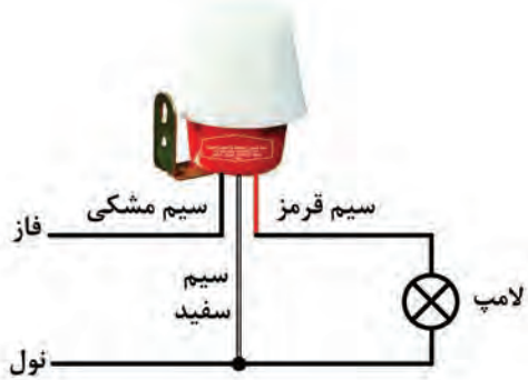
شکل ۲-۱۸- اتصال فتوسل به لامپ و شبکه
