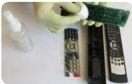
شکل ۱-۱۰- تمیز کردن کنتاکت‌ها با الکل
