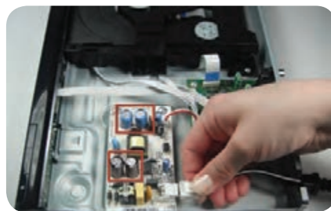
شکل ۶-۲۳ آزادکردن سوکت منبع تغذیه
