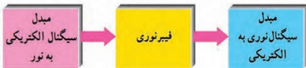
شکل ۴-۱۰- اساس یک سامانه فیبر نوری
