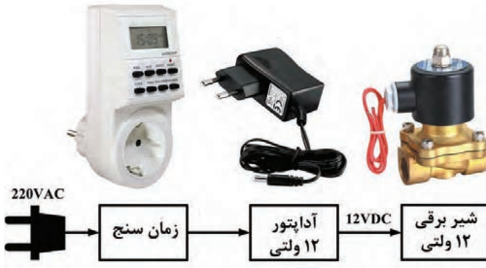
شکل ۲-۴۸- نصب شیر برقی ۱۲ ولت
