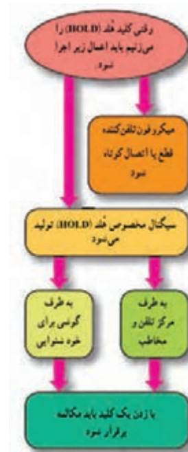
شکل ۳۲-۵- عملکرد مدار هلد
