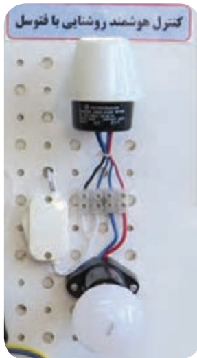
شکل ۲-۱۹- نحوه سیم‌کشی فتوسل
