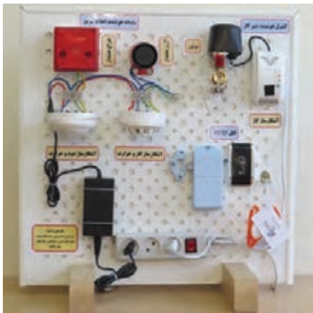
شکل ۳-۵۴- تابلوی اعلام حریق
