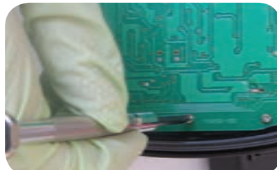
شکل ۱-۱۶- باز کردن پیچ‌های اتصال بدنه
