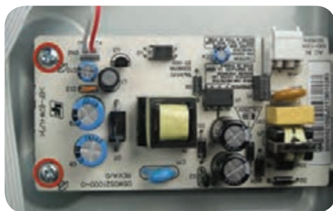
شکل ۶-۲۴ محل پیچ‌های محکم‌کننده برد منبع تغذیه
