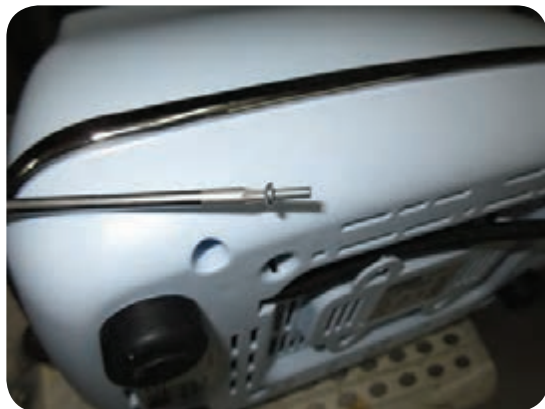
شکل ۶-۴۳ استفاده از ابزار خاص برای پیچ‌های ویژه
