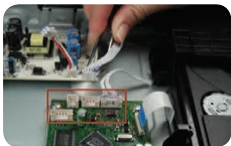
شکل ۲۰-۶ جدا شدن تمامی سوکت‌ها از برد
