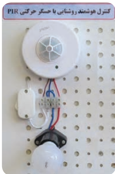
شکل ۲۹-۲ نحوه سیم‌کشی حسگر حرکتی PIR
