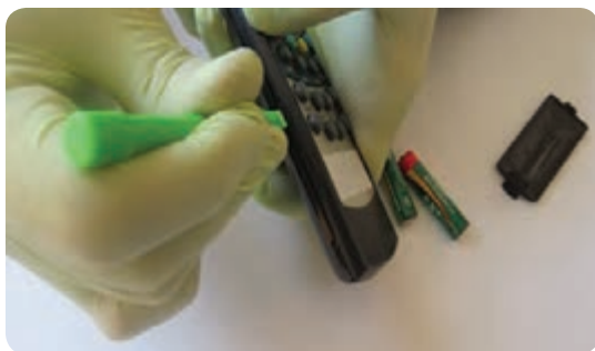
شکل ۸-۱ آزاد کردن خارهای قاب دستگاه ریموت کنترل
