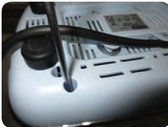
شکل ۶-۴۲ تشخیص نوع و محل پیچ‌های باز شده
