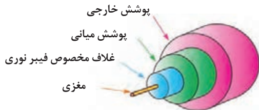
شکل ۴-۸- فیبر نوری و اجزای آن
