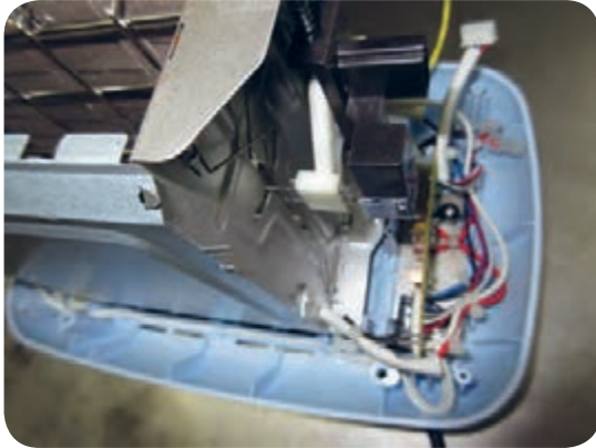
الف ب شکل ۵۶-۶ محل اتصال سیم زمین به نقاط مختلف توستر
