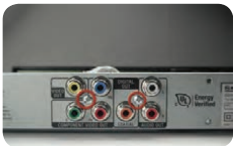
شکل ۲۲-۶ باز کردن پیچ‌نهایی برد پردازشگر
