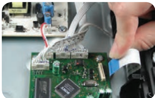
شکل ۱۸-۶ آزادسازی کابل پردازشگر
