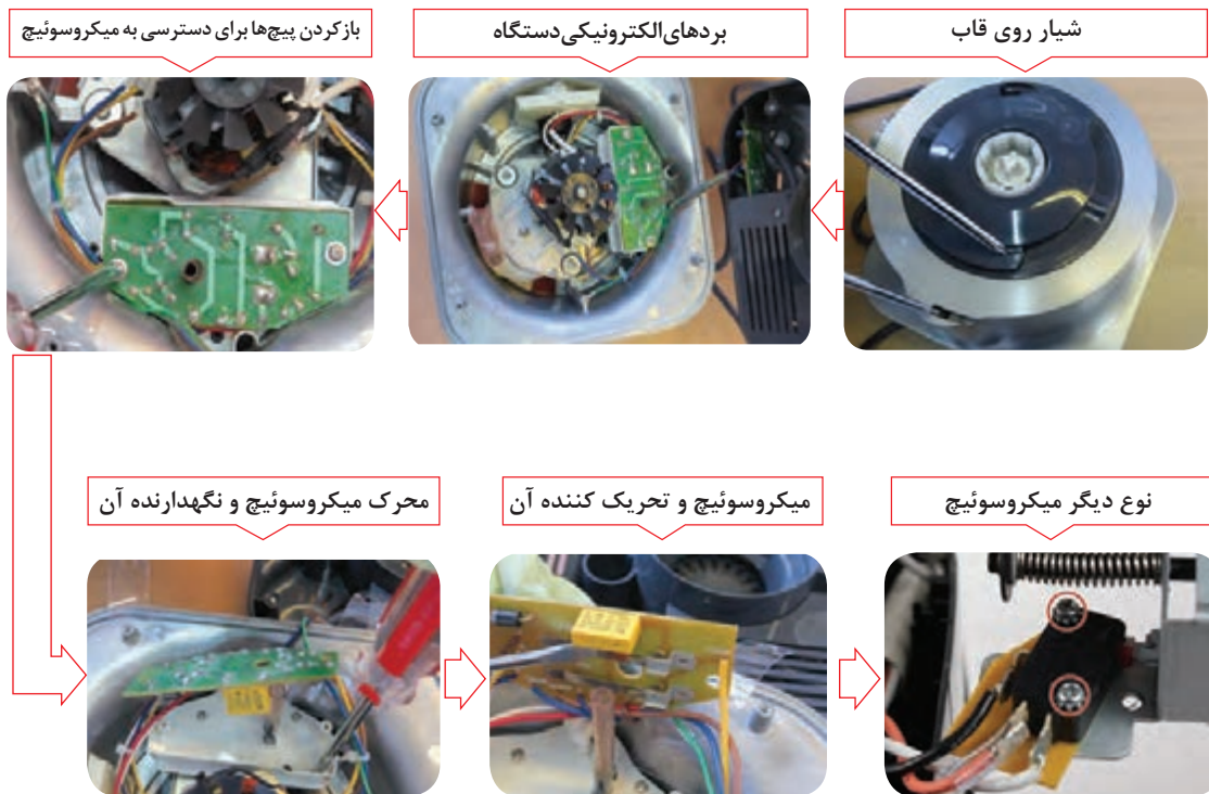
شکل ۲۵-۱- اینفوگرافی جدا کردن میکروسوییچ
