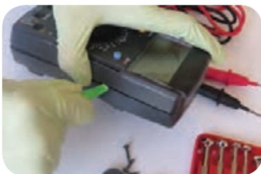
شکل ۱-۱۵- جدا کردن دو قسمت بدنه
