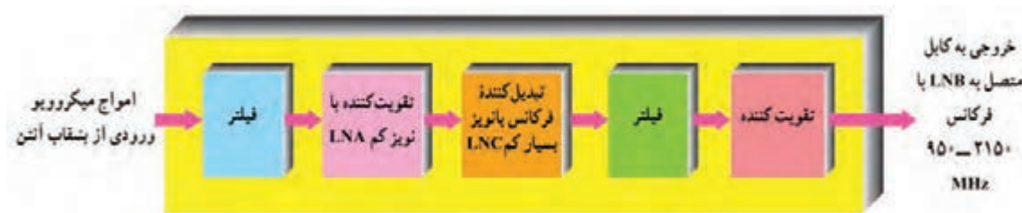
شکل ۴-۲۶- بلوک دیاگرام ساده LNB
