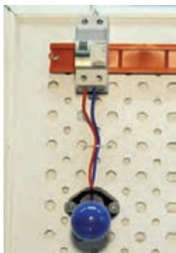
الف) قبل از عمل کردن کلید FI ب) بعد از عمل کردن کلید FI
